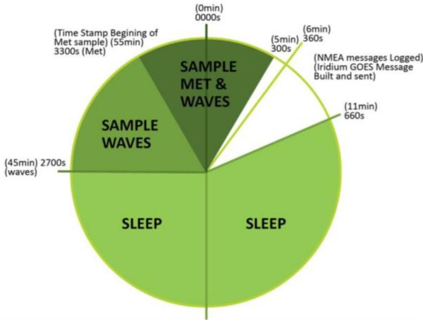
Le principal mécanisme de transmission des observations pour les bouées ayant la charge utile WM100 est la télémétrie par satellite (GOES). Historiquement, le programme de bouées ancrées du SMC
